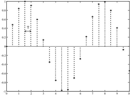
**Signaux discrets.** Un signal discret est défini sur une suite, finie ou non, d'instants  $t_n$ . En général  $t_n = nT$ , est un multiple entier d'un pas de temps élémentaire  $T$ .
