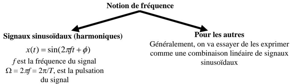
Le lien entre la représentation temporelle d'un signal et sa représentation fréquentielle est la décomposition en Série de Fourier (DSF), pour les signaux périodique ou la Transformée de Fourier (TF) pour les signaux non périodiques
