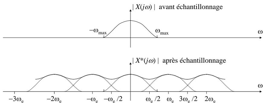
Il y a chevauchement des spectres voisins ; dans l'intervalle  $-\omega_e/2$  à  $\omega_e/2$  le spectre initial est dénaturé. Il n'est pas possible dans ce cas, de restituer le signal initial.
