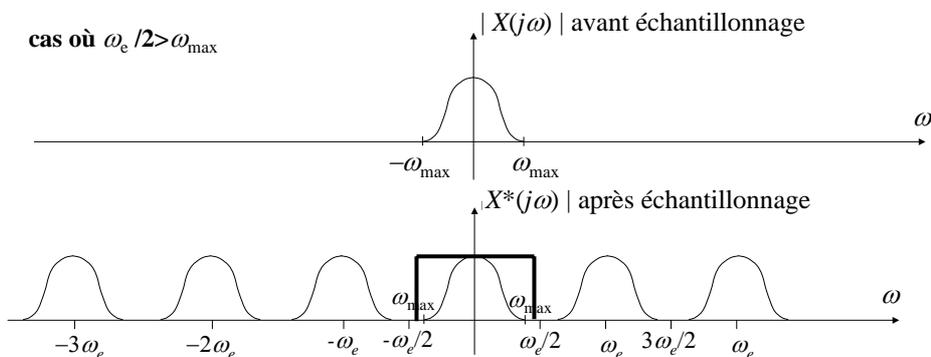
Le spectre initial n'est pas modifié dans l'intervalle  $-\omega_e/2$  à  $\omega_e/2$  ; donc un filtre avec une pulsation de coupure  $\omega_f$  tel que  $\omega_{\max} < \omega_f < \omega_e/2$  permet de récupérer le spectre utile et ainsi de reconstituer le signal avant échantillonnage.
