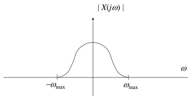
Deux cas sont alors à distinguer : le cas où  $\omega_e/2 > \omega_{\max}$  et le cas où  $\omega_e/2 < \omega_{\max}$
